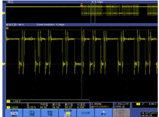
图 1：SPI 总线波形超调超过 34%
